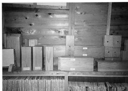
山中さんの事務所「木の家づくりネットワーク」は情報宝庫。木取りがひと目でわかるモデル(下)部材のサンプル(上)も手に取れる
